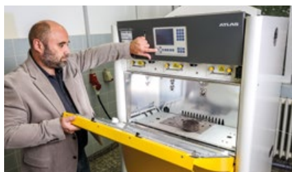
Gerät zur Xenonbewitterung von dreidimensionalen Proben
