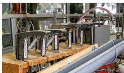
Waschtischarmaturen im Prüfstand zur Schwermetallmigration
