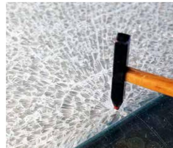
Prüfung der Bruchstruktur | Fragmentation test
