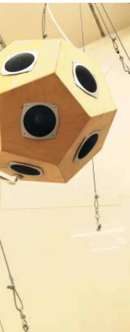
Lautsprecher im Hallraum des MPA-Akustik- labors (Foto links).
