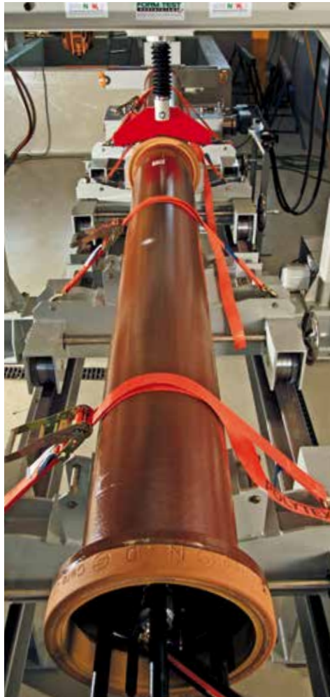
Strangprüfung auf Wasserdichtheit | Testing a tubular string for watertightness
