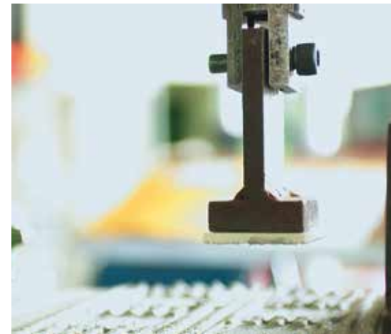
Ermittlung der Haftzugfestigkeit von Fliesenkleber | Determining the adhesive tensile strength of tile cement
