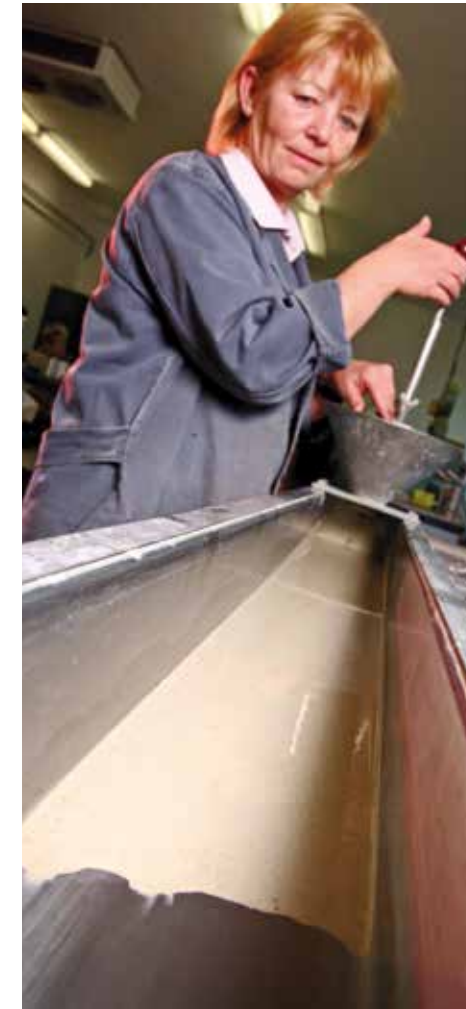
Ermittlung des Fließmaßes von Vergussmörtel | Determining the slump-flow of casting mortar
