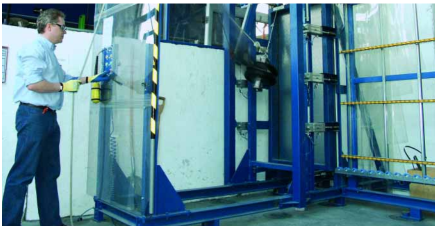
Eines der Highlights im Labor des MPA NRW: der kalibrierte Pendelschlag-Prüfstand.
