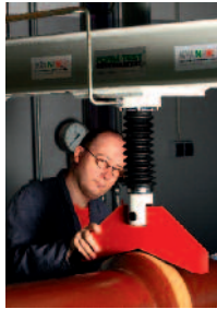
Realitätsnahe Prüfung der Muffenverbindungen
