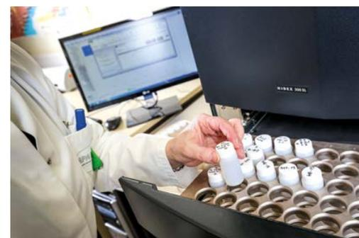
Probenauswertung mit einem Flüssigszintillationsspektrometer, beispielsweise zur Bestimmung von Tritium (oben); Überprüfungsmessungen an dekontaminierten Gebäudeflächen im Kernkraftwerk Würgassen (links)
