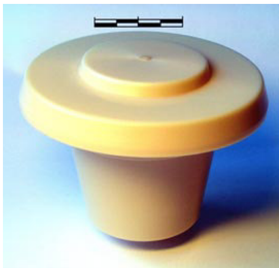
Radon-Ortsdosimeter komplette Diffusionskammer
