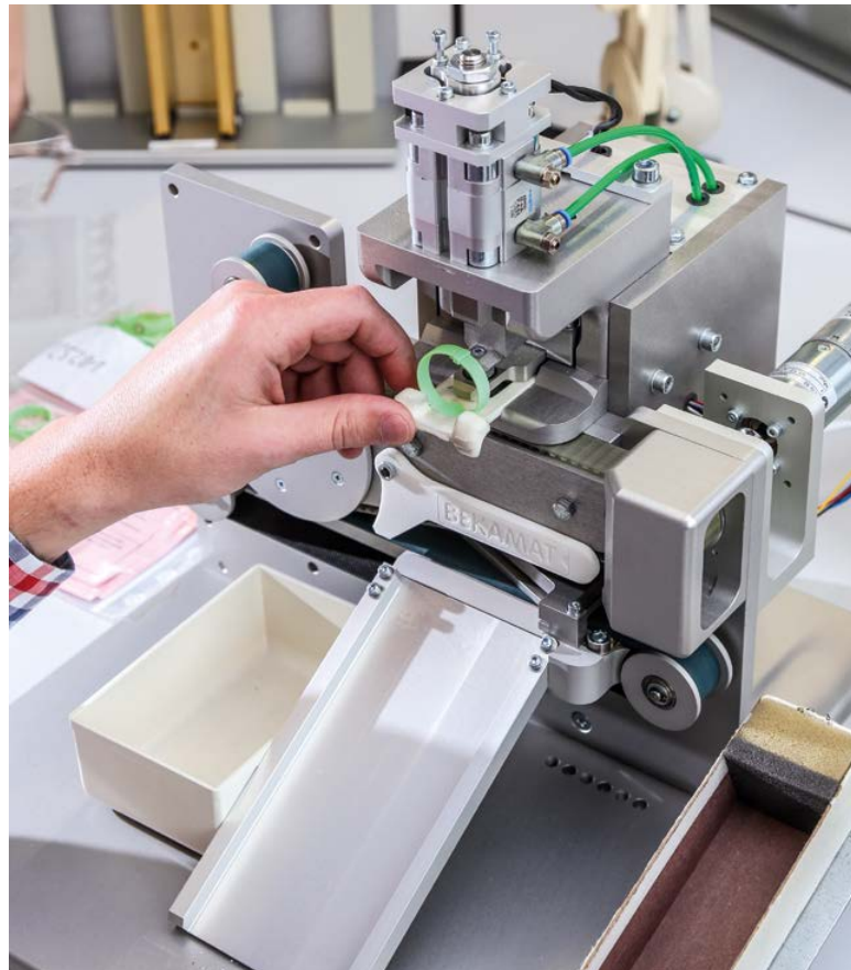
Automatische Entnahme des Detektors aus einem Fingerringdosimeter
