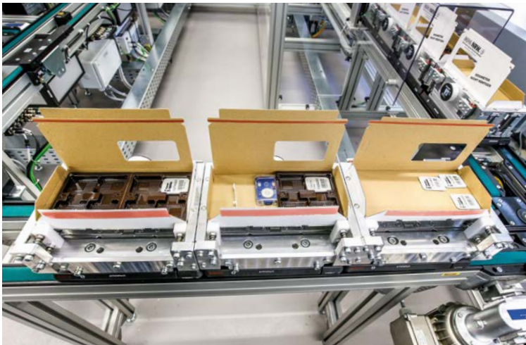
Automatisch Versandstraße mit rechnergesteuerter Befüllung der Dosimeter-Pakete
