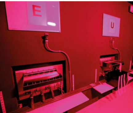
Dunkel Entwicklung der Dosimeterfilme – Einlaufseite des Automaten
