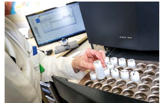
Probenauswertung mit einem Flüssigszintillationsspektrometer, beispielsweise zur Bestimmung von Tritium (oben); Überprüfungsmessungen an dekontaminierten Gebäudeflächen im Kernkraftwerk Würgassen (links)
