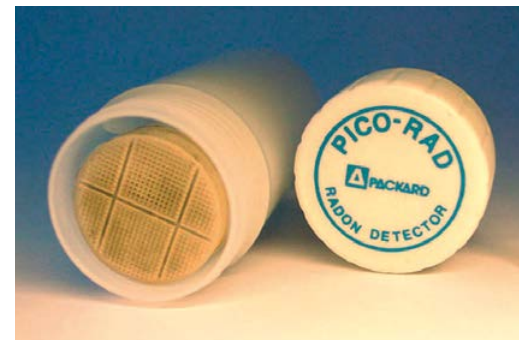
Aktivkohle-Radonsammler zur Schnellmessung der Radonaktivitätskonzentration
