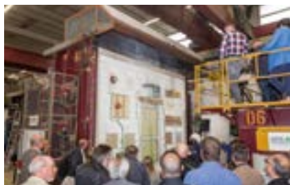
Brandschutztag im Brandprüfzentrum Erwitte: Massivwand mit Probekörpern
