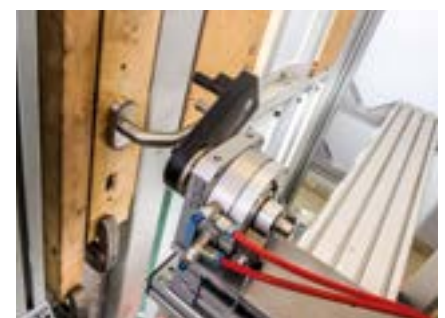
Dauerfunktionsprüfungen für Notausgangsverschlüsse gemäß EN 179
