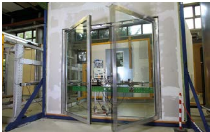
Dauerfunktionsprüfung an einer zweiflügeligen Tür
