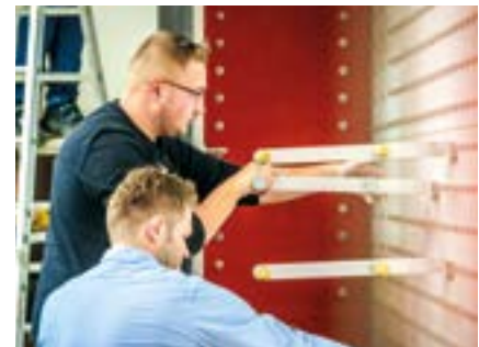
Dauerfunktionsprüfung an Panikverschlüssen (oberes Foto); Vorbereitung des Prüfstandes (unteres Foto)
