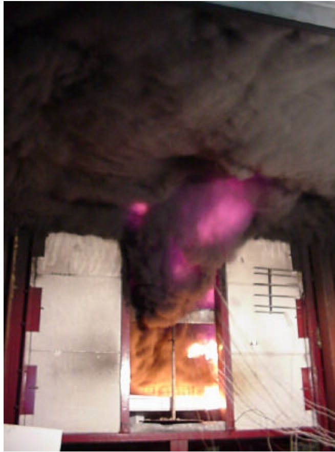
Bild 4: Flashover : Material PS 15 SE, 120 mm dick, Zündquelle 2 Holzwollekörbe.
