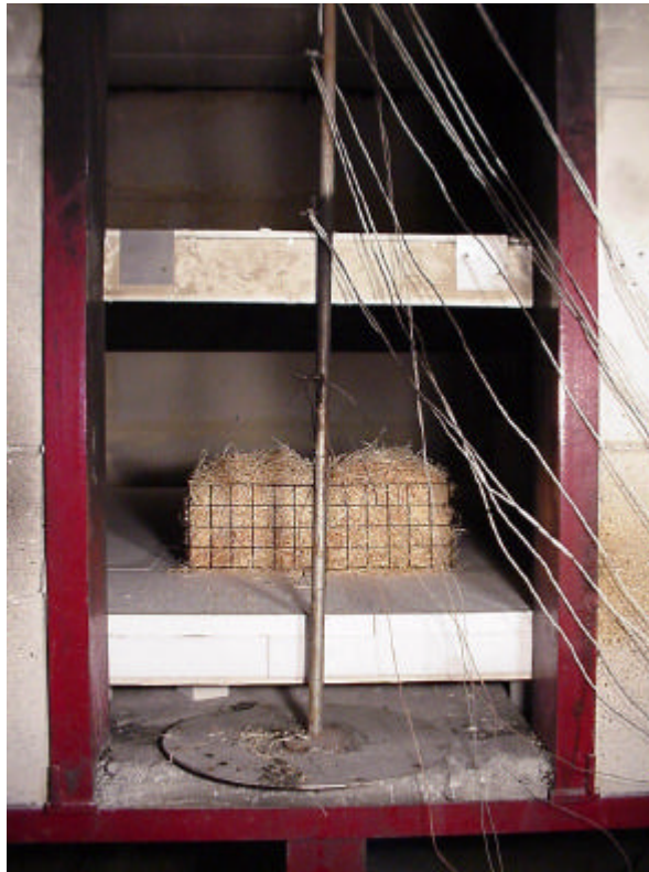
Bild 3: Vor dem Versuch. Zündquelle zwei Holzwollekörbe. Material PS 15 SE, 120 mm dick.
