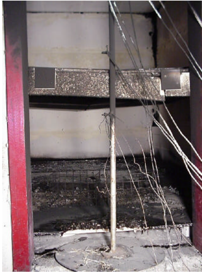
Bild 5: Nach dem Versuch: Material PS 15 SE 120 mm, Zündquelle 2 Holzwollekörbe.
