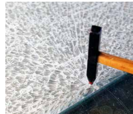
Prüfung der Bruchstruktur | Fragmentation test
