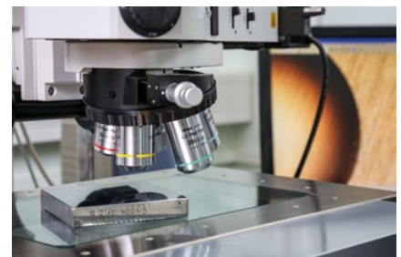
Ausmessung eines Kalibriereindrucks nach Brinell
