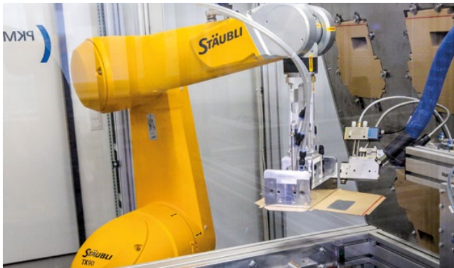
Per Roboterarm wird die benötigte Zuschnittgröße aus dem Vorrat entnommen, mit Heißkleber bestrichen und über eine Aufrichtschablone in den wartenden Transportwagen eingesetzt.
