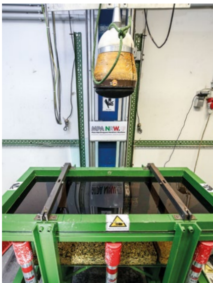
Phantomfallprüfung mit Verzögerungsmessung zur Bestimmung des Verletzungsrisikos bei einem Aufprall des Kopfes eines Fahrzeuginsassen auf eine Kunststoffscheibe.
