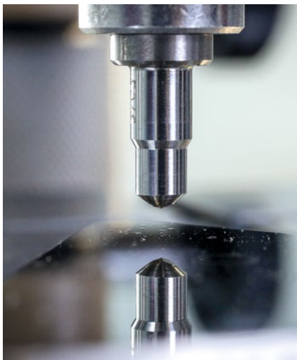
Vickers-Eindringkörper bei der Annäherung an die Oberfläche
