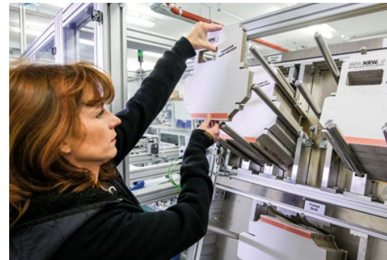
Der Tagesbedarf an Kartonzuschnitten für drei verschiedene Packungsgrößen wird in der Maschine bereitgehalten. Das Nachfüllen bleibt Handarbeit.
