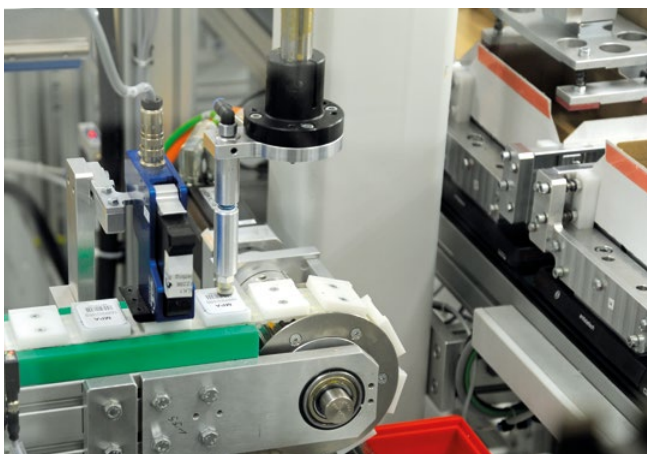
Jede einzelne Filmpackung wird erfasst (Barcode) und einzeln in den wartenden Karton gefüllt. Optional kann die Filmpackung z. B. mit dem Namen des Trägers bedruckt werden.
