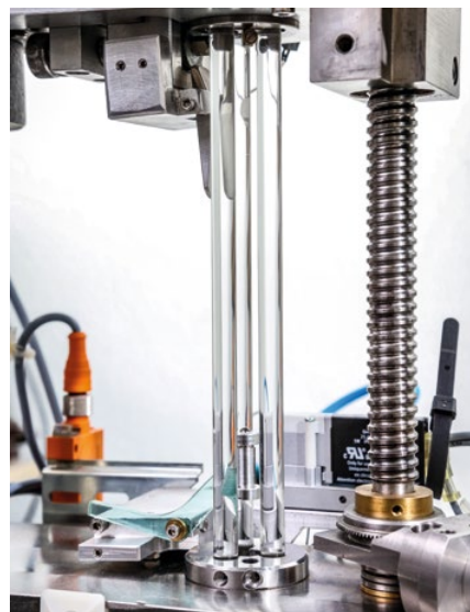
Fallkörper vor dem Auftreffen auf die Oberfläche bei Kalibrierung einer Härtevergleichsplatte nach Leeb (Foto links)
