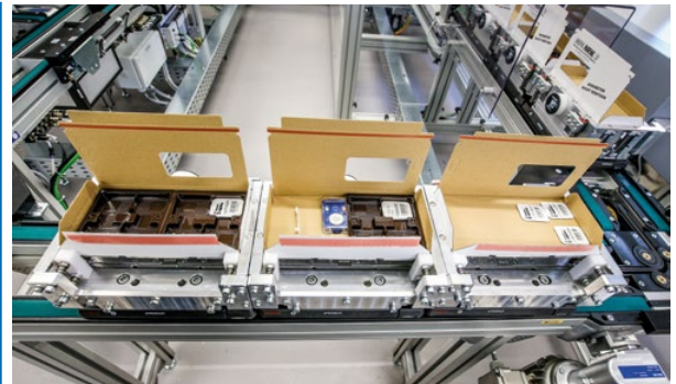
Teilgefüllte Packungen auf dem Transportweg durch die Versandanlage
