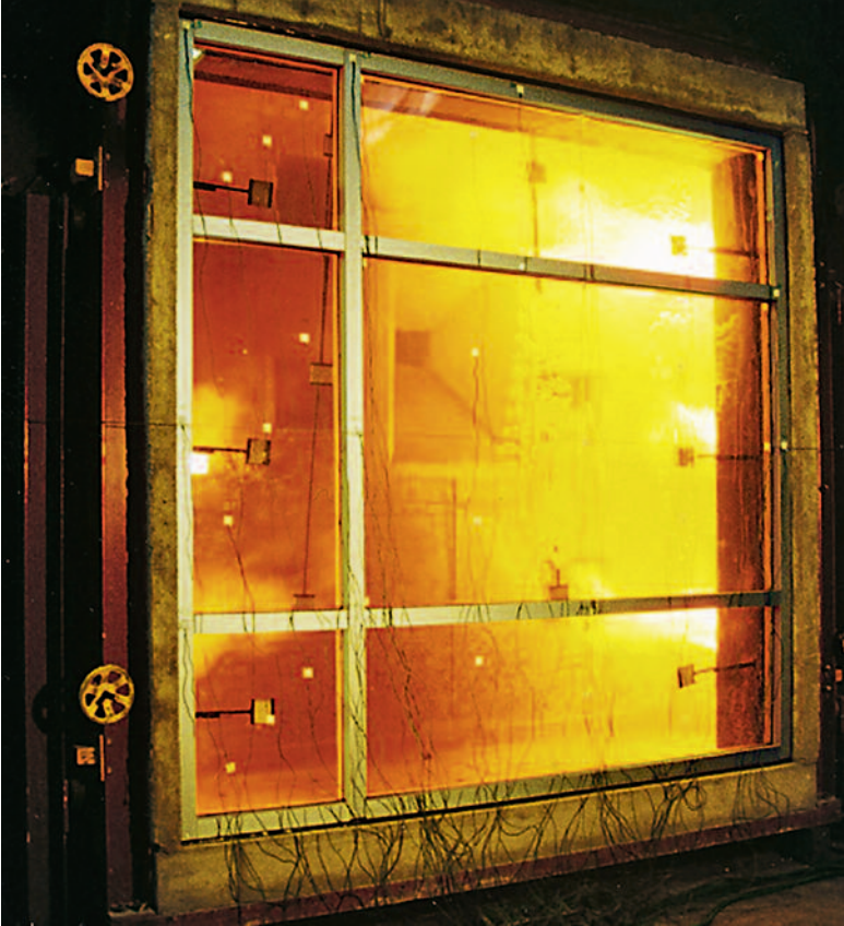
Kurz nach dem Start der Brandprüfung mit Ölbeflammung an einer 3 x 3 Meter großen Verglasung
