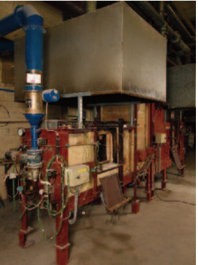
Zwei Öfen nach DIN 4102-8 für Vergleichs- und Überwachungsprüfungen
