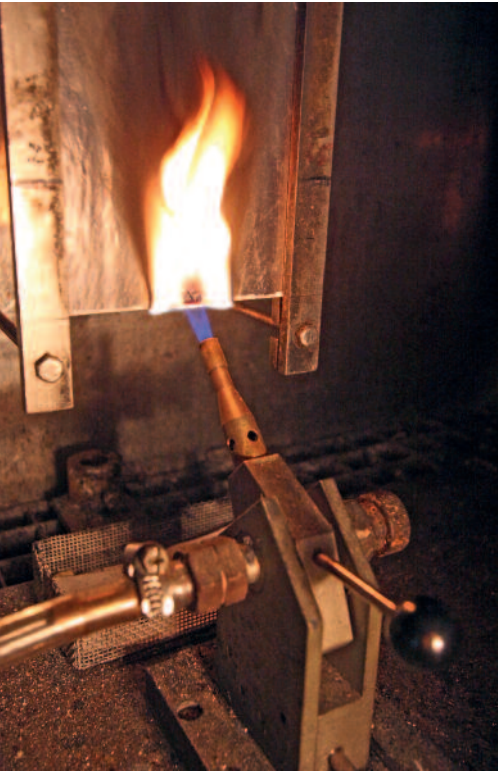
Entzündbarkeitsprüfung nach DIN EN ISO 11925-2 oder DIN 4102-1, Baustoffklasse B2
