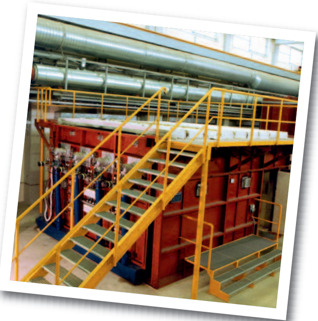
Multifunktionsofen mit Gasbeflammung für europäische Prüfungen vertikaler und horizontaler Bauteile
