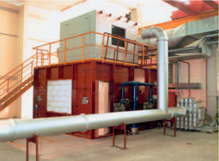
Deutschlands einziger Ofen nach DIN 4102-6 zur Prüfung von horizontalen und vertikalen Lüftungsleitungen
