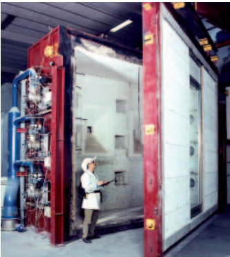
Kontrolle des 5 Meter breiten und 4 Meter hohen Probekörpers vor der Brandprüfung mit Gasbeflammung
