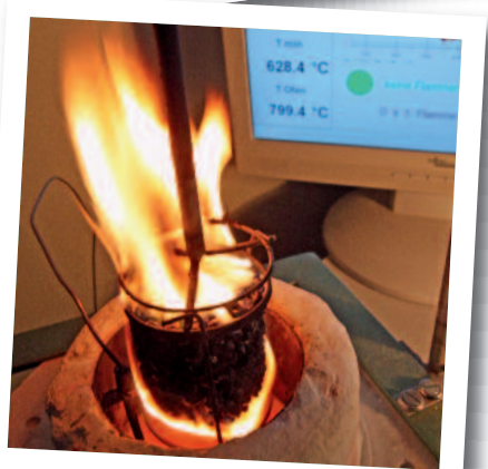
Europäisches Prüfverfahren „Nichtbrennbarkeitsofen“ nach DIN EN ISO 1182
