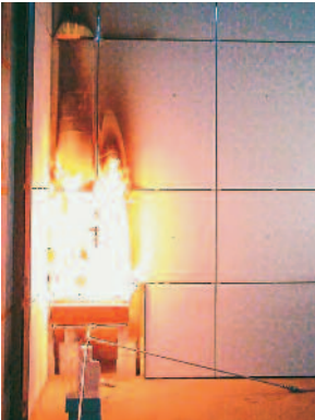
Großversuch im Maßstab 1:1 für Außenwandbekleidungen
