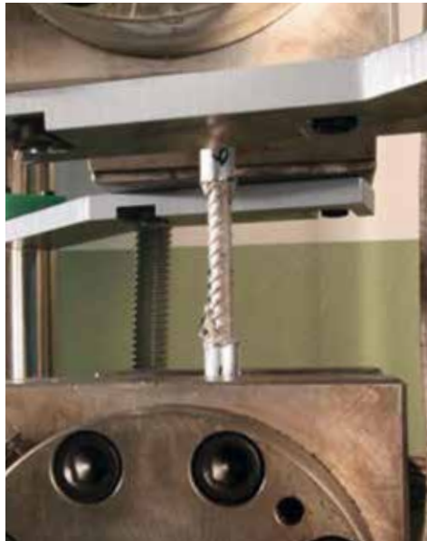
Dynamische Prüfung an Betonstahl nach DIN EN ISO 15630 | Dynamic test on reinforcing steel according to DIN EN ISO 15630
