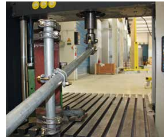
Drehwinkelsteifigkeit an Gerüstkupplungen nach DIN EN 74-1 | Rotation angle stiffness test on scaffold couplers according to DIN EN 74-1
