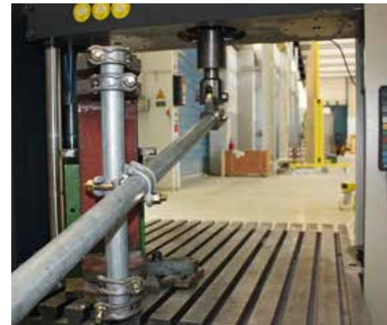
**Drehwinkelsteifigkeit an Gerüstkupplungen nach DIN EN 74-1** | Rotation angle stiffness test on scaffold couplers according to DIN EN 74-1
