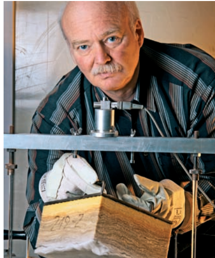
Ralf Bertram bei der Prüfung von Wärmedämmstoffen im MPA-Labor
