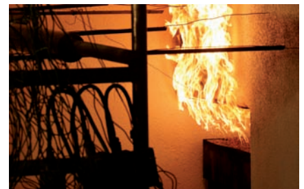
Prüfung des Brandverhaltens von Wärmedämm-Verbundsystemen
