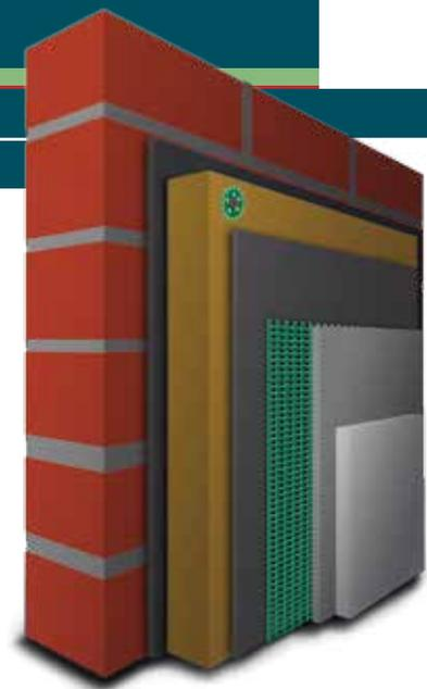
**Wärmedämmverbundsysteme bestehen aus verschiedenen Komponenten: Dämmung, Armierung, Putze und Befestigung.**
