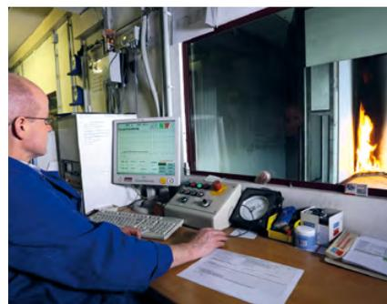
**Ein Mitarbeiter des MPA NRW im Beobachtungs- und Schaltraum des SBI-Prüfstandes.**
