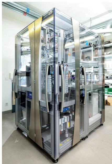
Anlage zum Entblistern der TL-DOS-Chips. Die Detektoren werden aus den Blisterverpackungen gestanzt und in Magazin-Karusselle abgelegt.
