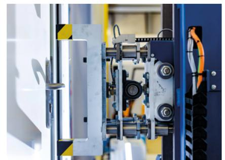
Prüfung der statischen Belastung am Verriegelungspunkt.
