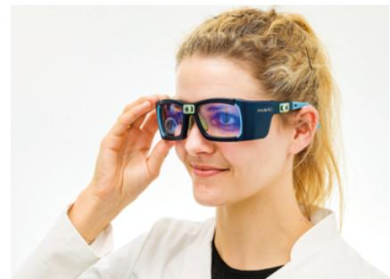
Strahlenschutzbrille mit zwei Augenlinsendosimetern zur Bestimmung der Augenexposition.
