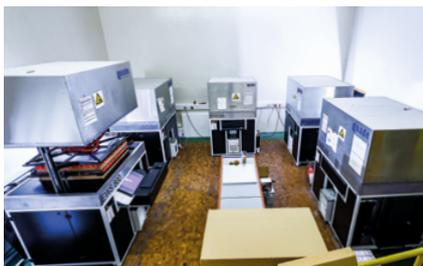
Prüflabor mit Geräten zur Ermittlung der Wärmeleitfähigkeit
