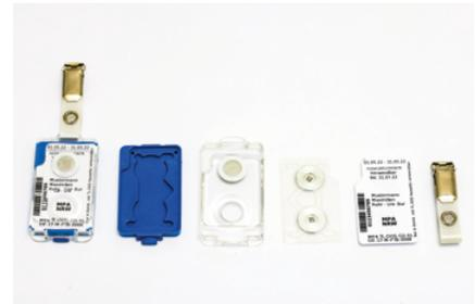
Das TL-DOS-System (Abbildung) ist eine Eigenentwicklung des MPA NRW – in Zusammenarbeit mit der TU Dortmund. Es liefert kein Bild mehr wie das ausgemusterte Film-Personendosimeter, sondern Messkurven. Die TL-DOS-Detektoren mit der Größe einer 2-Cent-Münze werden in eine Blister-Verpackung eingeschweißt, die am Kittel der Trägerin oder des Trägers befestigt wird. Nach Ablauf der Verwendungszeit wird die Verpackung mit der wiederverwendbaren Messsonde an das MPA NRW zur Auswertung zurückgeschickt.
