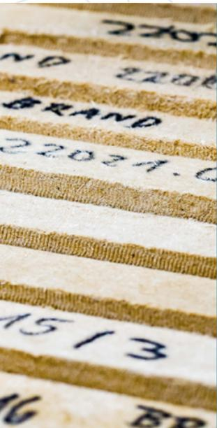
Die Probekörper werden vor der Prüfung zugeschnitten und mit einer Codierung versehen. Damit können die einzelnen Platten den Kunden zugeordnet werden.
