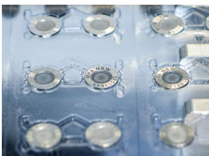
Detektorchips in der Verblisterungsanlage. Jeweils drei Detektorpaare werden hier parallel verarbeitet.
