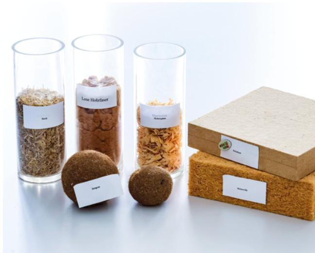
Wärmedämmstoffe aus nachwachsenden Rohstoffen werden immer häufiger eingesetzt, sogar in Verbundsystemen.
