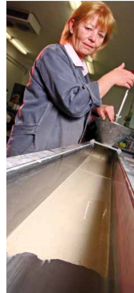
Ermittlung des Fließmaßes von Vergussmörtel | Determining the slump-flow of casting mortar
