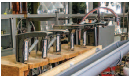
Waschtischarmaturen im Prüfstand zur Schwermetallmigration
