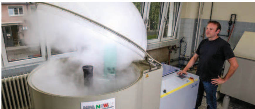
Salzsprühkammer nach DIN EN ISO 9227
