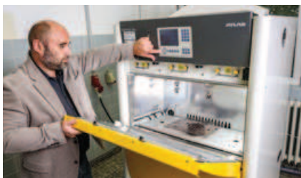
Gerät zur Xenonbewitterung von dreidimensionalen Proben
