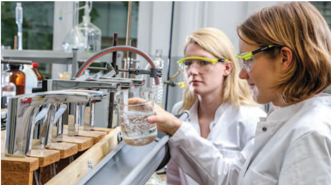
Die Auszubildenden zur Chemielaborantin bei der Probenentnahme am Prüfstand zur Schwermetallmigration
