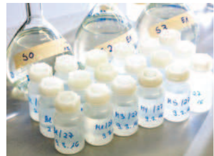
Wasserproben zur Messung des Schwermetallgehaltes (unten)
