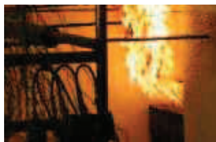
Prüfung des Brandverhaltens von Wärmedämm-Verbundsystemen.
