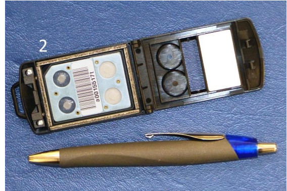
2. Innenansicht mit Vier-Element-Detektorkarte (blau, nummeriert) und Neutronenabsorber (weiß bzw. grau)
