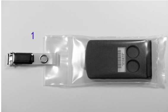
1. Vorderseite Die Schutzhülle ist Teil der Dosimetersonde und darf keinesfalls entfernt werden!
