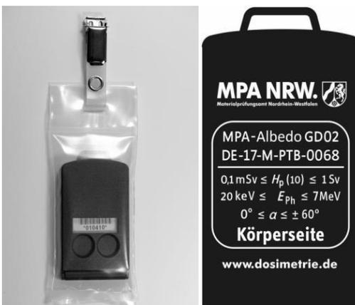
Passives Personendosimeter für Gamma- und Neutronenstrahlung. 4 Detektoren mit LiF:Mg Ti als sensitiver Schicht. Das Dosimeter muss in der Folie eingeschweißt bleiben, um die Auswertung nicht zu gefährden.
