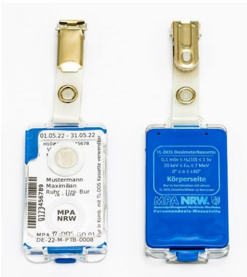
Passives (= ohne Energiebedarf messendes System zur späteren Auswertung in geeigneten Messgeräten) Personendosimeter für Röntgen- und Gammastrahlung. Zwei Detektoren mit LiF:Mg,Ti als sensitiver Schicht auf Aluminium-Substraten.
