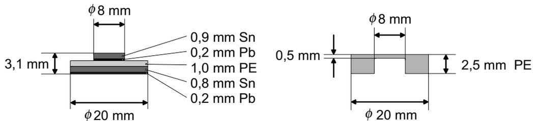
**Bild 11:** Aufbau und Abmessungen von Metall- (links) und Plastikfilter (rechts) in der neuen Filmkassette.
