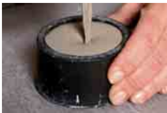
Untersuchung von Spezialmörtel im Baustoff-Labor: Entspricht das Fließverhalten den Anforderungen der Norm?
