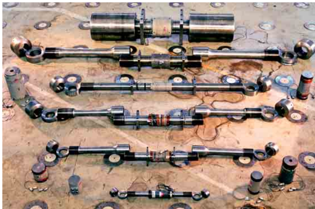
Zusammenstellung von Kraftaufnehmern für große Kräfte, die das MPA NRW bei der Prüfung und Kalibrierung von Prüfmaschinen einsetzt. Zum Maßstab: Der Abstand der Spanntöpfe im Hallenboden beträgt zirka einen Meter.
