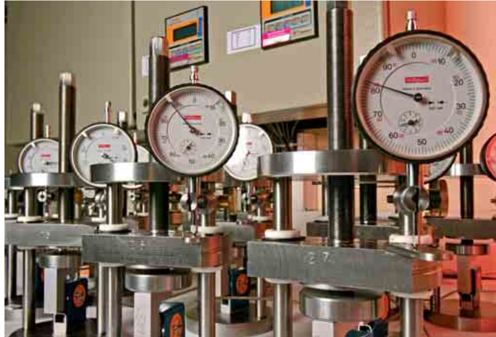
Das MPA NRW besitzt zwei Ozonprüfkammern (Fotos oben) und 40 Messgeräte zur Bestimmung der Druckspannungsrelaxation (unten).
