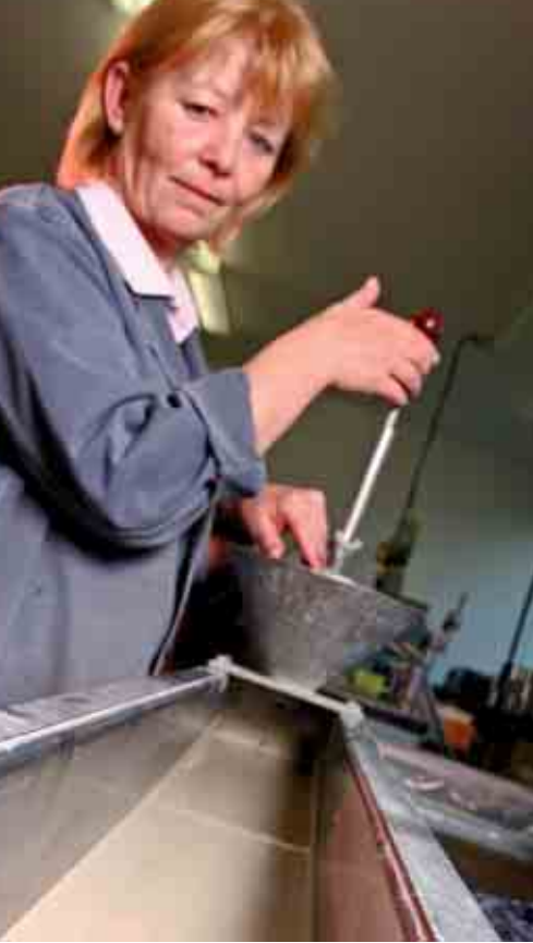
Untersuchung von Spezialmörtel im Baustoff-Labor: Entspricht das Fließverhalten den Anforderungen der Norm?
